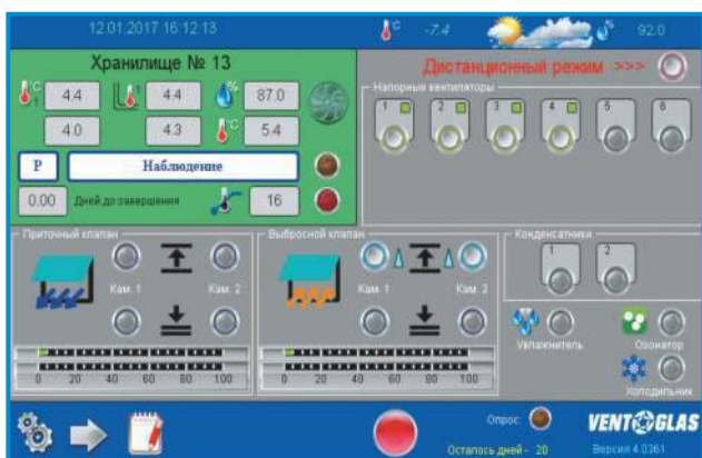
Домашний экран СПК с включенным «Дистанционным режимом», при котором доступно он-лайн ручное управление.
