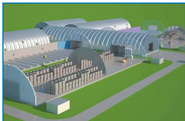
3D модель комплекса для навалного и контейнерного хранения плодоовощной продукции.
