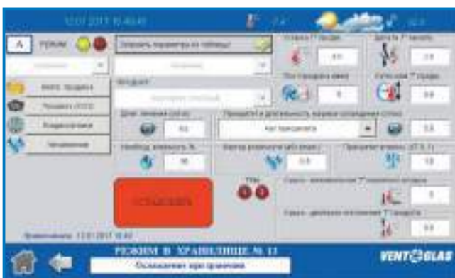
В окне настройки автоматического режима отображаются все доступные настройки вентиляционной системы.
