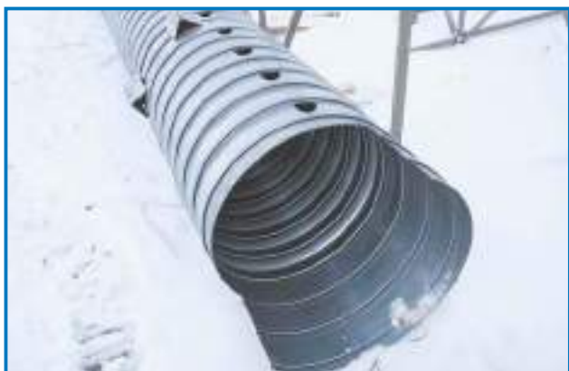
Кагатные трубы VENTOGLAS™ заканчиваются патентованным S-образным замком, который облегчает обоюдное соединение.
